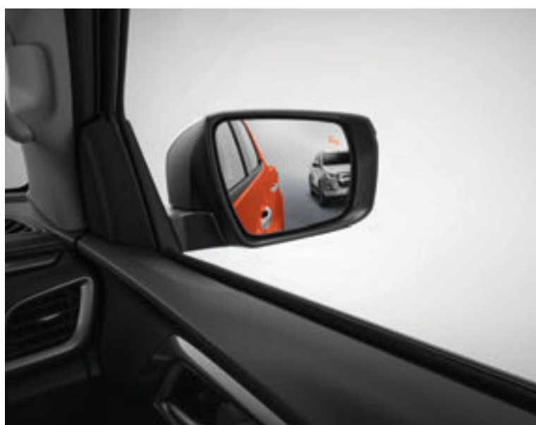
BSM (Blind Spot Monitor) – sistem detekcije vozila u "mrtvom uglu"
