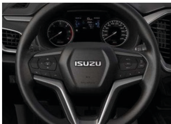
Električna servo asistencija koja pruža bolji osećaj u svim uslovima vožnje. "Lakši volan" pri malim brzinama i parkiranju, a "teži" pri većim brzinama, obezbeđuje idealan odnos udobnosti i bezbednosti
